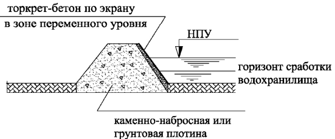
Рисунок 6.3 - Применение торкрет-бетона при ремонте ж/б экрана
